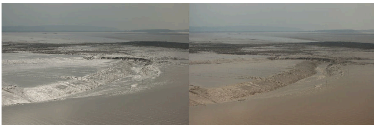
Rys. Wynik działania polaryzatora na odbicie od przybrzeżnej równiny błotnej. Na rysunku po lewej stronie ustawiony pionowo polaryzator przepuszcza przede wszystkim odbicia. Obrócenie polaryzatora o 90^\circ (po stronie prawej) wycina prawie wszystkie tak spektakularne refleksy.
